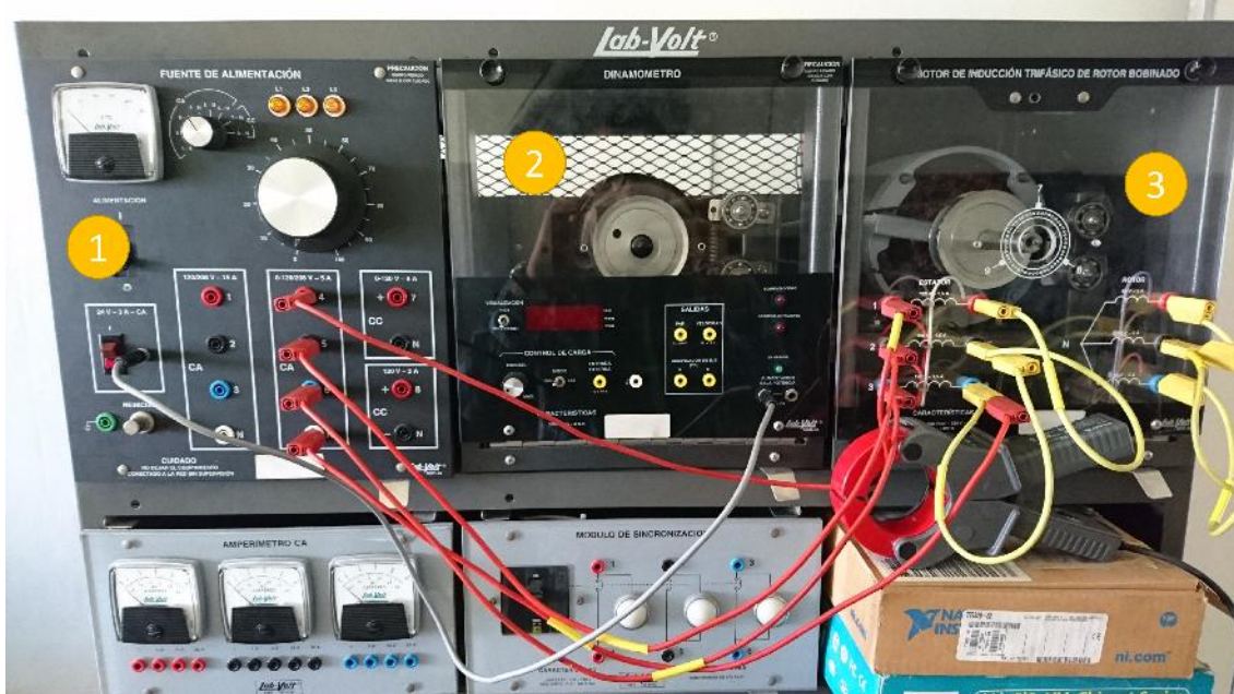
Figura 3.19. Conexión de la fuente de voltaje (1), dinamómetro (2) y la máquina de inducción (3)
